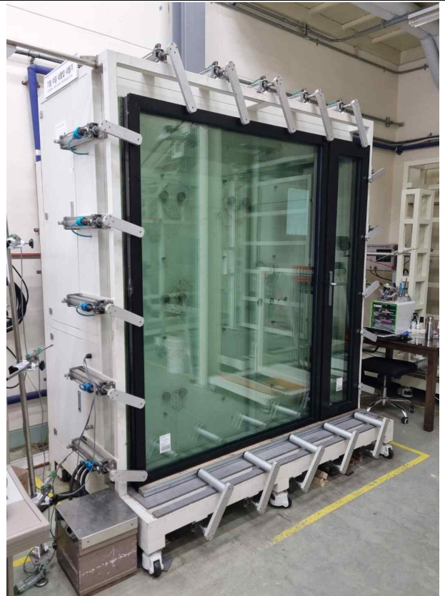
<사진 2> 기밀 시험체 사진(측면)
